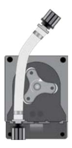
Stecken Sie den linken Anschluss in das entsprechende Gehäuse und führen Sie den Schlauch unter der Rollenführung hindurch. Drehen Sie die Rolle in Richtung des kreisförmigen Pfeils und führen Sie gleichzeitig den Schlauch durch den Pumpenkopf zum rechten Anschluss.
