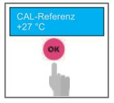
Verwenden Sie zur Kalibrierung des Temperatursensors einen handgehaltenen Controller
