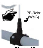
Phase 12 Schrauben Sie die Kappe mit dem PE-Rohr (weiß) auf das Ventil.
