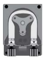
Schließen Sie den Pumpendeckel und drücken Sie fest auf seine Oberfläche, damit er einrastet.
